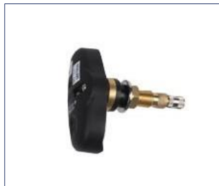
Датчик - вентиль для тракторів та іншої СГ техніки
